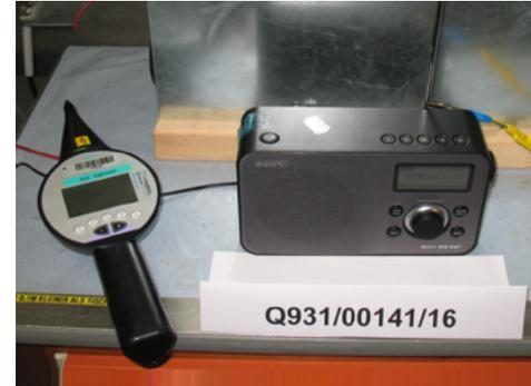
Prüfung Elektrostatische Entladung
